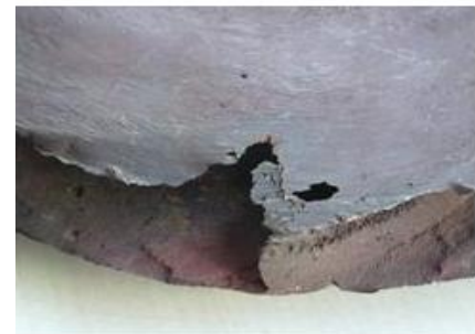
FIGURA 2. Impulsor de bomba centrífuga seriamente dañado por los efectos de la cavitación.
