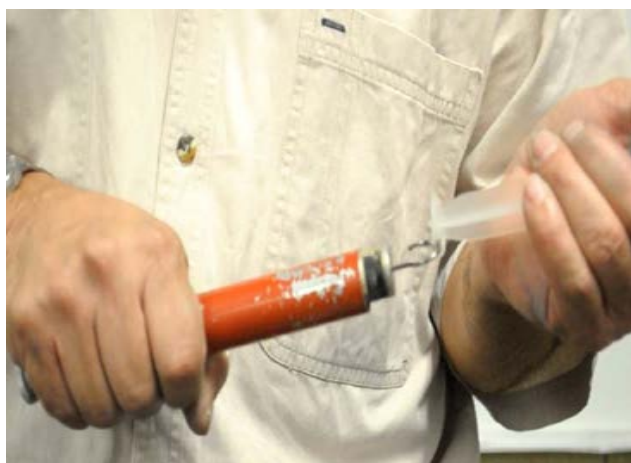
FIGURA 1. Obteniendo el peso de una columna de aire de la atmósfera por medio de un dinamómetro adaptado a una jeringa.
