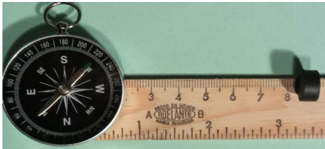
FIGURA 4. El ángulo Theta es de 45^\circ para el imán de cerámica, quitando el imán la aguja apunta al norte.
