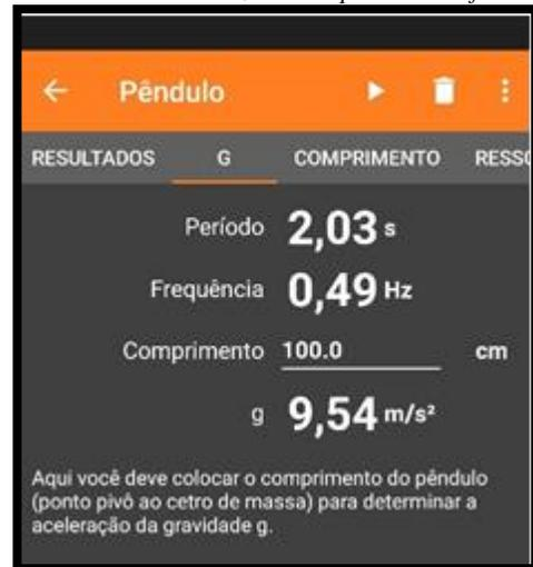
**FIGURA 3.** Resultado da frequência do pêndulo simples quando abandonado sob a ação da aceleração gravitacional a um ângulo de aproximadamente  $10^\circ$ . Fonte: Dados da pesquisa.
