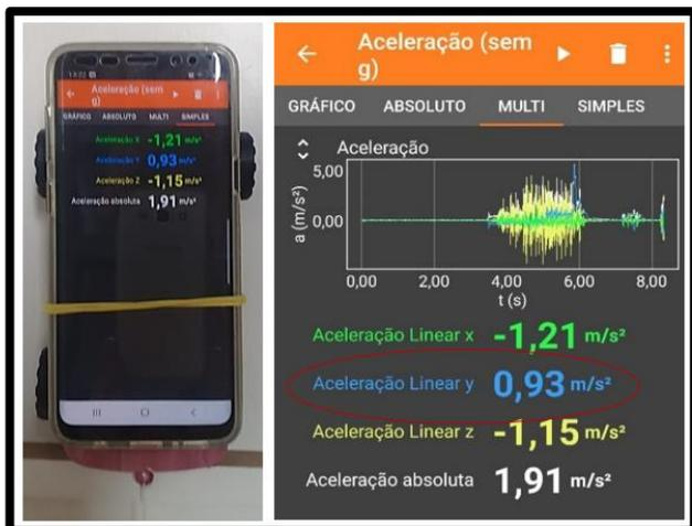
FIGURA 6. Resultado do experimento de movimento uniformemente variado (MUV), no *Phyphox*. Fonte: Acervo dos autores.
