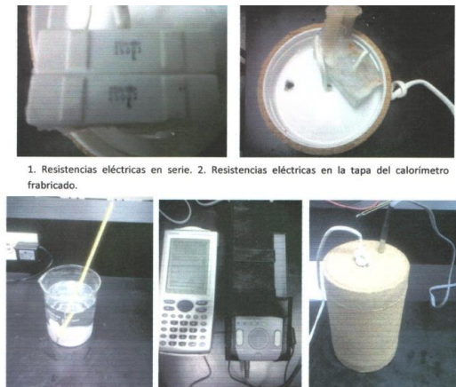
FIGURA 3. Montaje Experimental del equivalente eléctrico del calor con la tecnología instrumental.
