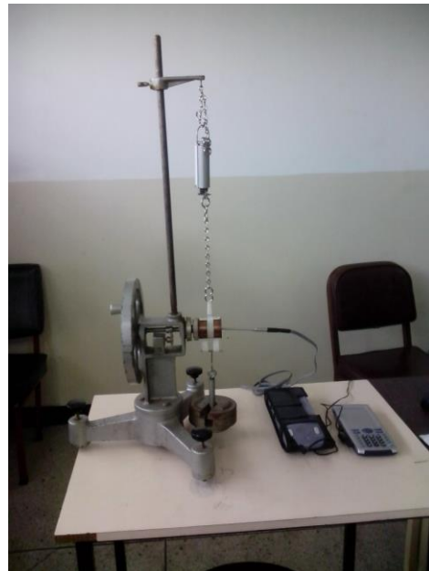
FIGURA 1. Fotografía del montaje experimental del equivalente mecánico del calor.
