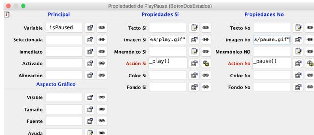
**FIGURA 10.** Edición de las propiedades para el elemento botón de dos estados PlayPause. Se muestra la variable `_isPaused` y las Acción si `_play()`, junto con la Acción no `_pause()`, que controlan el estado de correr o pausar la animación.
