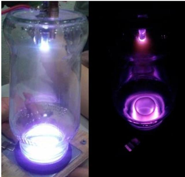
**FIGURA 4.** Se muestra el plasma generado por el esquema experimental en la Figura 3. A la izquierda se muestra un plasma utilizando electrodos con recubrimiento de Zinc. A la derecha se muestra un plasma generado con electrodos de cobre.
