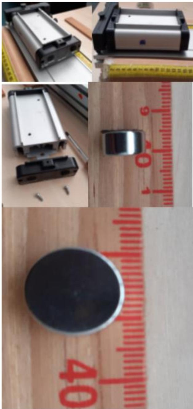
**FIGURA 2.** Imagens do carrinho, da régua para medição e dos ímãs cilíndricos. Os ímãs cilíndricos são encaixados na parte frontal dos carros.
