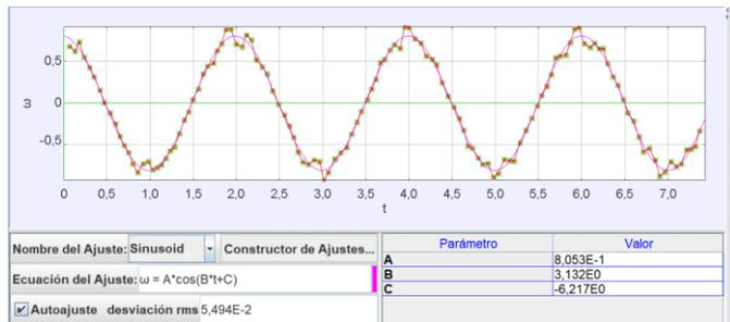
**FIGURA 15.** Gráfica de la velocidad angular en función del tiempo para el sistema masa-cuerda sin fricción obtenida con Tracker.
