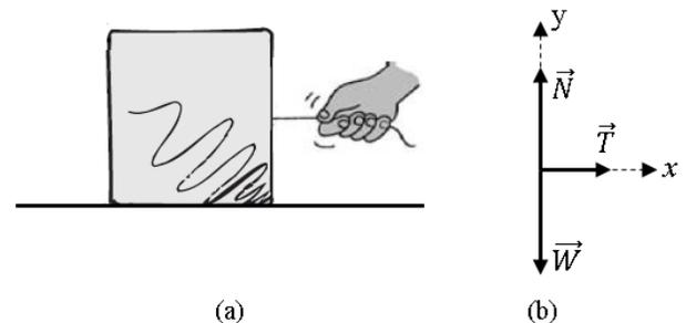
**FIGURA 2.** (a) Un bloque de masa  $m$  se mueve sobre una superficie horizontal lisa, jalado por una cuerda que ejerce una tensión constante. (b) Diagrama de cuerpo libre correspondiente al bloque mostrado en (a). Se considera positiva la dirección hacia la derecha.
