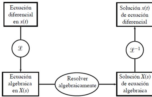
**FIGURA 4.** Diagrama que muestra cómo se utiliza el método de transformada de Laplace para resolver una EDO con condiciones iniciales conocidas.
