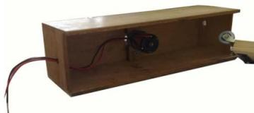
FIGURA 2. Base del Aparato y motor DC.
