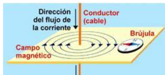
FIGURA 2. Líneas de campo magnético alrededor del alambre conductor de corriente [5].
