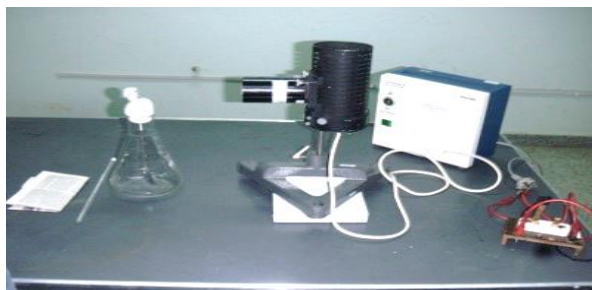
FIGURA 1. Montaje experimental. Visualización de forma cualitativa del efecto fotoeléctrico.
