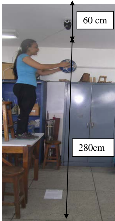
FIGURA 2. Ensayo del lanzamiento en caída libre de un balón de Fútbol. Toma de video y fotografía.
