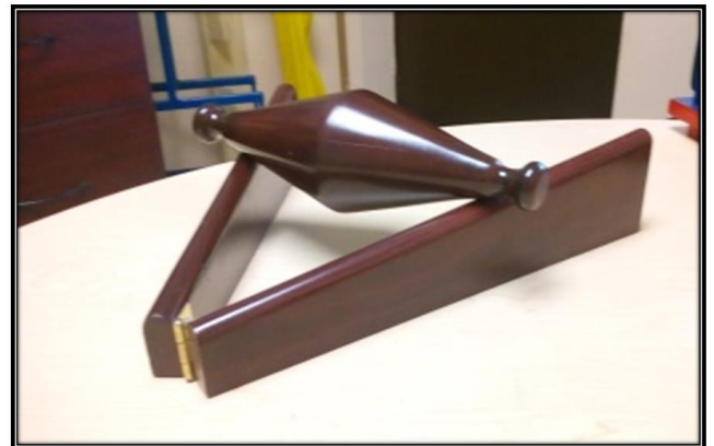
FIGURA 7. Caso de la Paradoja Mecánica, bicono-PI construido de madera, y cuyo ángulo \gamma , de los rieles es variable.
