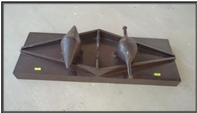
FIGURA 6. caso de modo “doble pendiente”: cuyo sistema de Bicono con rieles de madera, y cuyas dimensiones son de 90 cm de longitud y 30 cm de ancho y 10 de altura, el riel inclinado tiene un ángulo de 5 grados.
