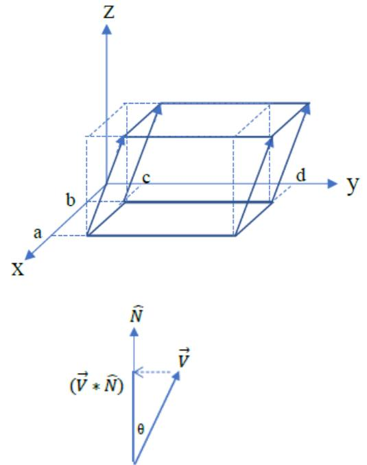
**FIGURA 3.** Representación gráfica del volumen formado al imaginar una compuerta rectangular en el piso del salón de clases y que por cada punto de ella fluye agua al interior del salón en forma no perpendicular al piso, pero ahora con velocidad constante.
