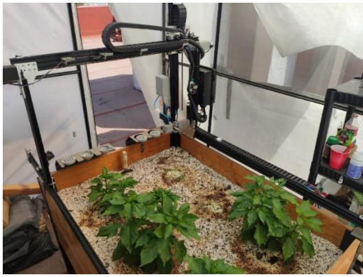
FIGURA 1. Sistema mecatrónico, construido principalmente con piezas aluminio y plástico montado en un invernadero.
