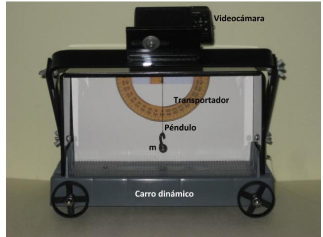
FIGURA 4. Imagen del carro dinámico con un péndulo al interior y una videocámara.
