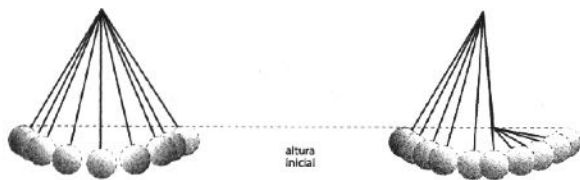
FIGURA 1. Péndulo de Galileo. Se muestra que la esfera siempre llega a la misma altura en el lado simétrico, independientemente de dónde coloquemos el obstáculo.
