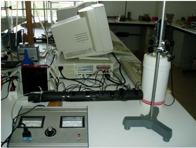
FIGURA 2. Montaje experimental en el que puede verse la resistencia calefactora extraída de la barra y colocada sobre el extremo izquierdo de la misma y el vaso Dewar en el que entra el extremo derecho de ésta.
