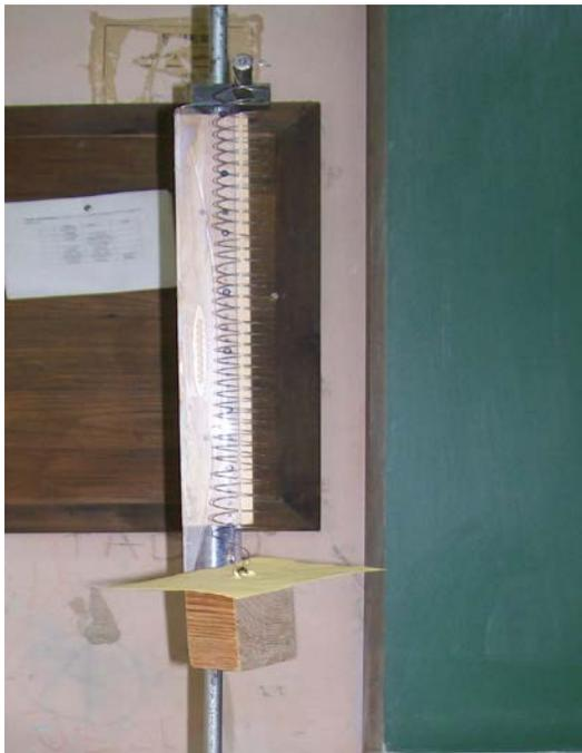
FIGURA 7. Dispositivo presentado en la clase. Sistema masa-resorte con freno aerodinámico.
