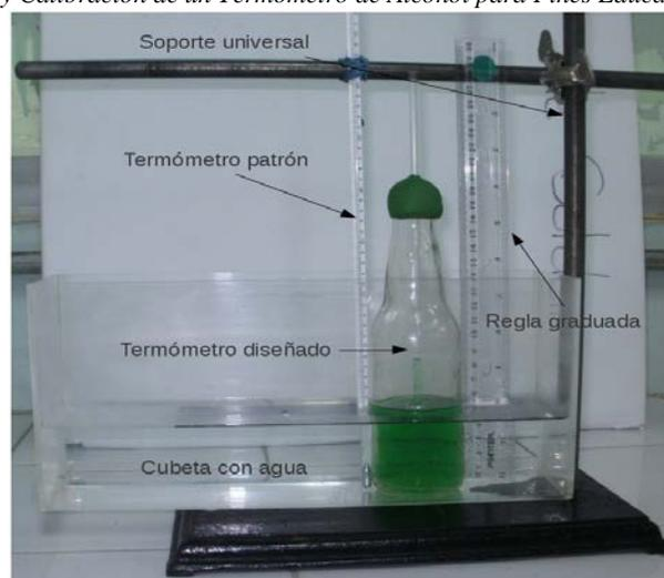
FIGURA 2. Montaje experimental.
