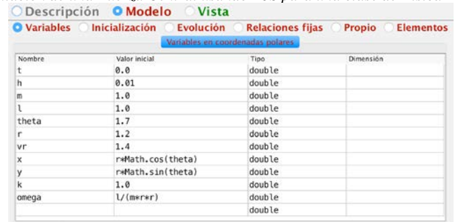
FIGURA 2. Lista de variables para la simulación de una partícula en un campo de fuerza central que sigue la ley de Hooke.
