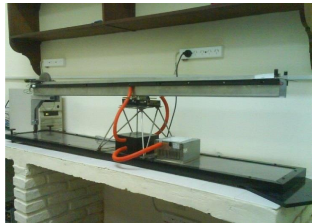
FIGURA 2. Montaje experimental riel inclinado-volante ( http://galileo4.unl.edu.ar/ ).
